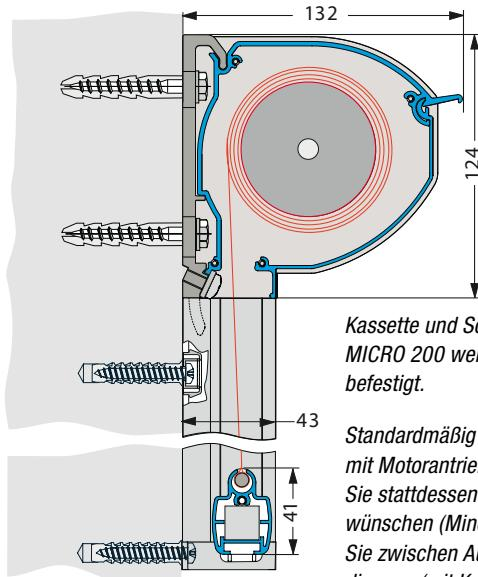
Kassette und Schienen der MICRO 200 werden an der Wand befestigt.
