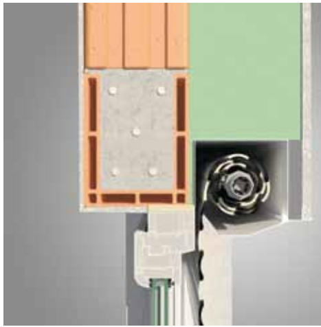
Möglichkeit 2: WDVS-Neubauanwendung eines Punext-Rollladens, Beispiel Putzmauerwerk/WDVS.
